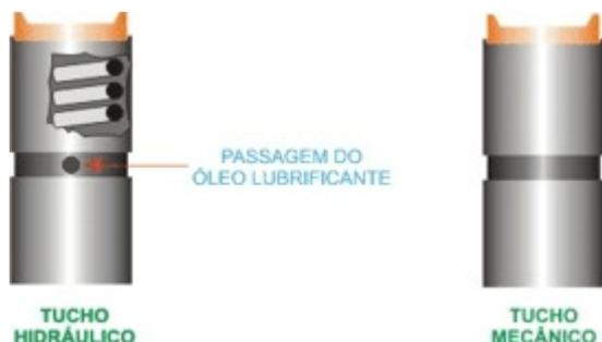
O tucho mecânico é totalmente sólido, ou seja, tem seu corpo rígido enquanto que o tucho hidráulico é oco formando internamente um cilindro com um êmbolo. Este êmbolo é mantido para fora pela força de uma mola.
